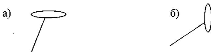
Рисунок 1.3 - Схемы рулевых колес грузового и легкового автомобилей
