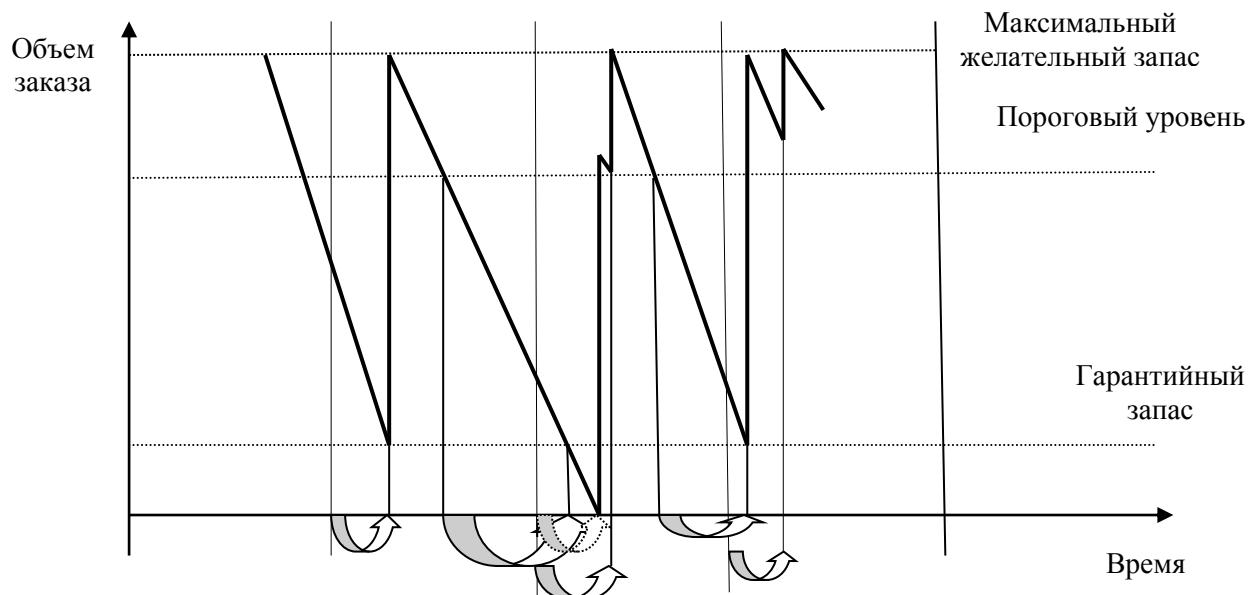
Рис. 18. График движения запасов в системе управления запасами с установленной периодичностью пополнения запасов до постоянного уровня
