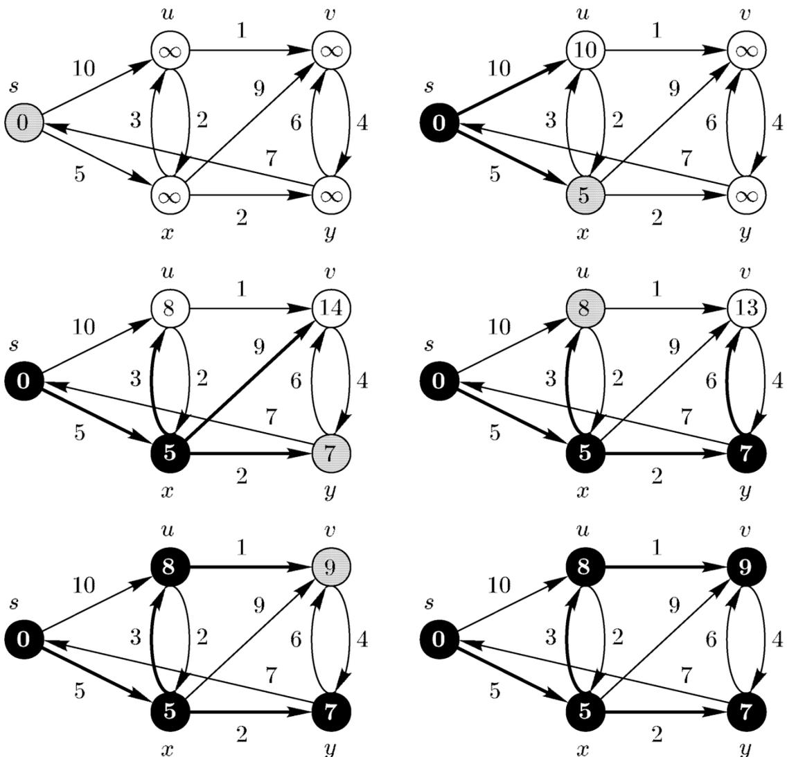
Рисунок 4.8 – Последовательные состояния после каждой итерации алгоритма Дейкстры
