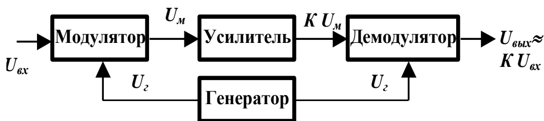
Рисунок 1.13. Структурная схема УПТ с преобразованием
