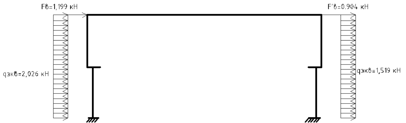
Рис. 17. Расчетная схема рамы при ветровой нагрузке слева направо
