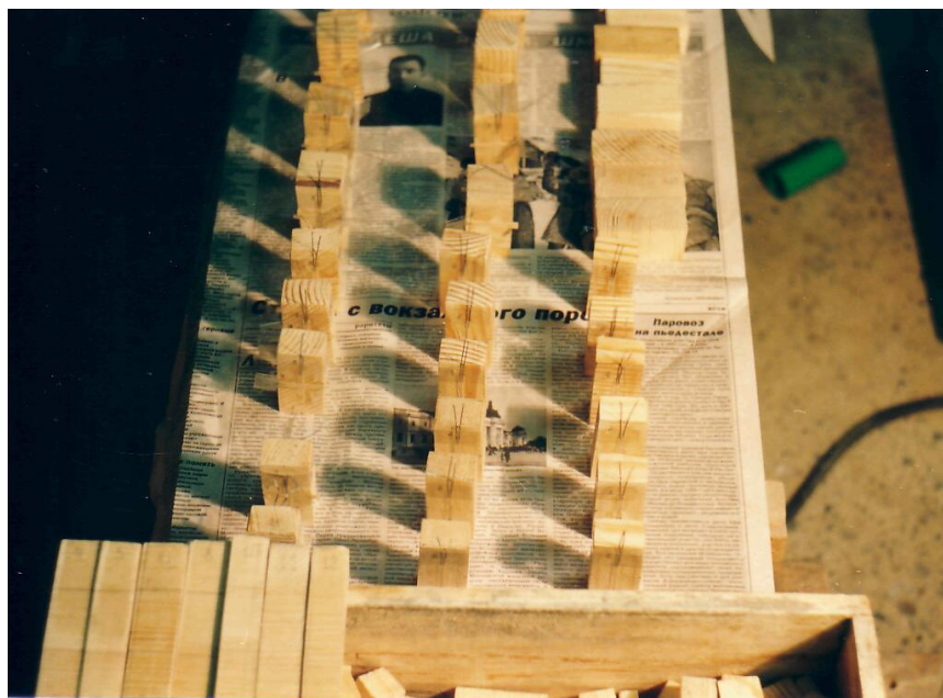
Рис. 2 Деревянные образцы с тензорезисторами для определения упругих характеристик
