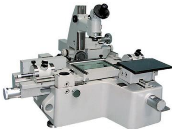
Рисунок 6 – Микроскоп измерительный универсальный УИМ-21
