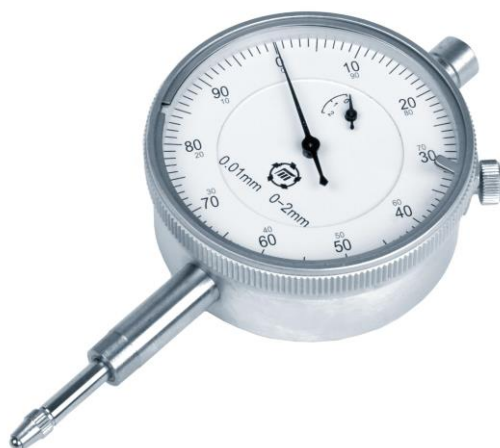
Рисунок 4 – Индикатор часового типа ИЧ-2
