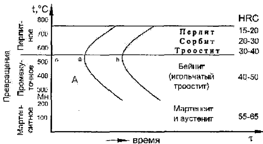
Рисунок 7.4 – Диаграмма изотермического распада аустенита для стали У8
