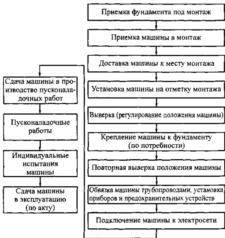
Рисунок 3.2 – Схема технологических операций, выполняемых субподрядчиками
