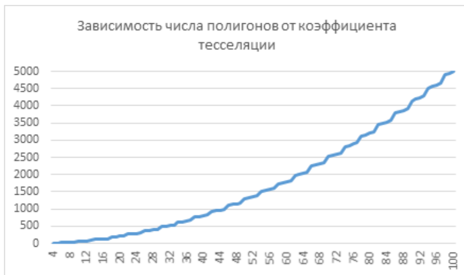
Рис. 2. Зависимость числа полигонов от коэффициента тесселяции
